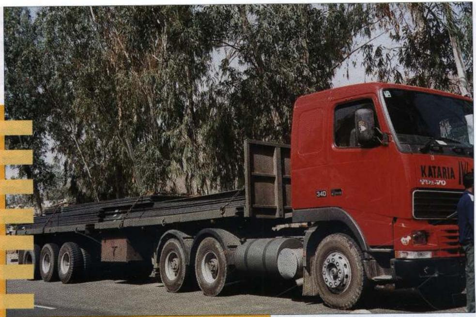
На полуприцепе 72 т груза. Грузоподъемность автопоезда 30 т. Как следствие, взорванные колеса, выгнутые в обратную сторону рессоры. Один штатный домкрат уже не справляется
