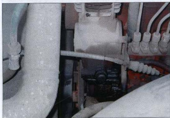
Привод воздушного компрессора — главный источник расхода моторного масла
